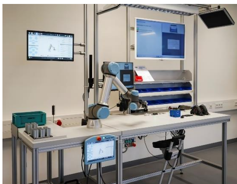
Modellarbeitsplatz für die manuelle Zylindermontage in der Industrie-4.0-Lernfabrik
