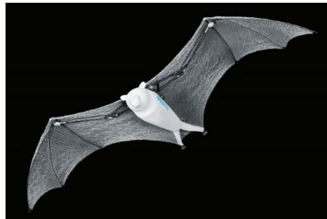
Bei einer Spannweite von 228 cm und einer Körperlänge von 87 cm wiegt der BionicFlyingFox nur 580 Gramm. Fotos: Festo AG & Co. KG
