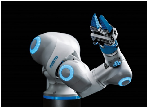
BionicCobot: Pneumatischer Leichtbauroboter mit menschlicher Bewegungsdynamik als feinfühligster Helfer für die Mensch-Roboter-Kollaboration. Fotos: Festo AG & Co. KG
